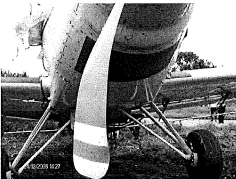
Daño a las palas de la hélice y tip del ala derecha.
