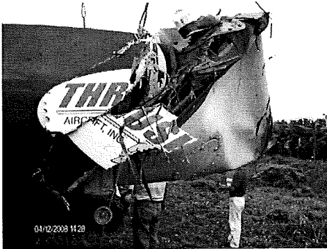
Daño al tip de ala derecha
