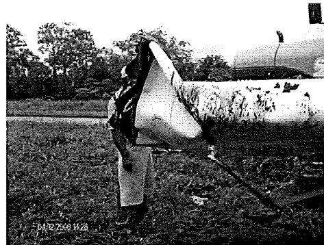
Daño a las palas de la hélice y tip del ala derecha.
