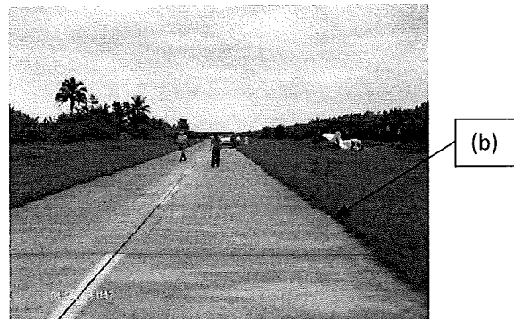
(a) Rastro dejada por la aeronave sobre la grama al salirse de la pista. (b) Marcas dejadas por la llanta al salirse de la pista
